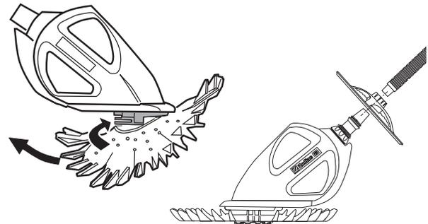
Glissez la roue déflectrice au-dessus de l'extension du boyau; appuyez jusqu'à ce qu'elle s'enclenche. (ÉU/Mexique Seulement) La roue déflectrice doit tourner librement.
